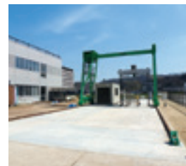
大型構造物載荷試験装置
