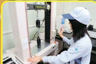
通常業務は作業室内で行います。写真は試作テープの強度をチェックする作業風景。
