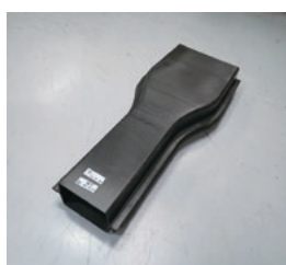
熱可塑性CFRPで作った開断面ビーム
