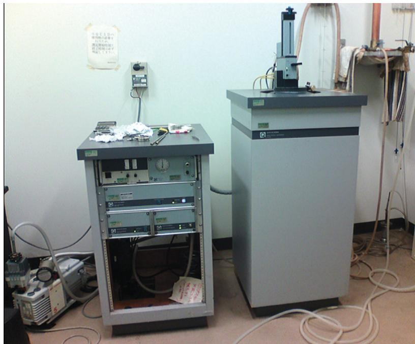
図 27: 超伝導量子干渉素子 (SQUID) を使用した磁気特性測定装置 (Quantum Design 社製 SP5000) の全景写真 (PC 部分を除く).
