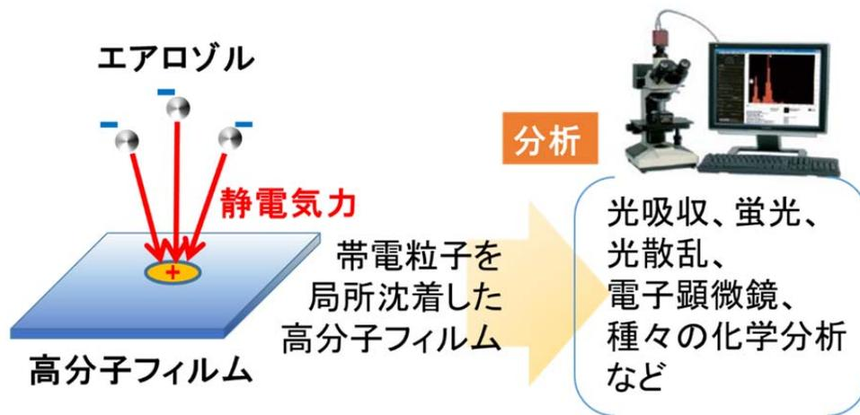
図 5-1 高分子フィルム上への帯電粒子の静電沈着
