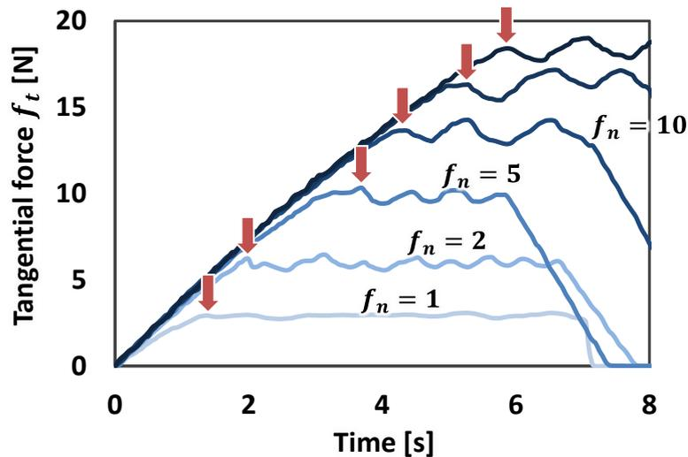
図 2.3-7 S1 における負荷した接線方向の荷重の時系列データ。
