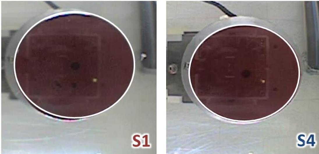
図 2.3-6 法線力 20[N] 負荷時の S1 と S4 の接触面の画像。
