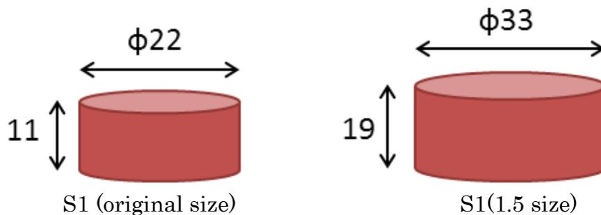
図 2.4-2 使用した指 (素材は前節の S1 のシリコンゴム).
