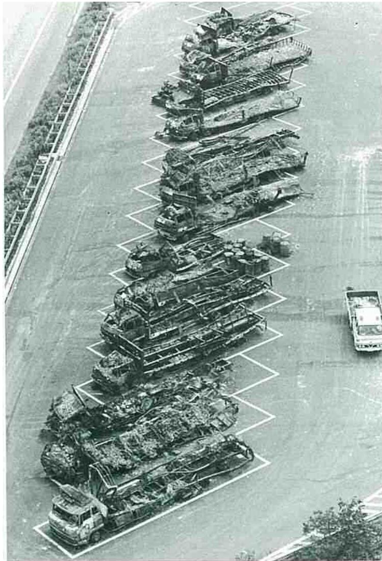
写真-4.3 日本坂トンネル火災の延焼車両
