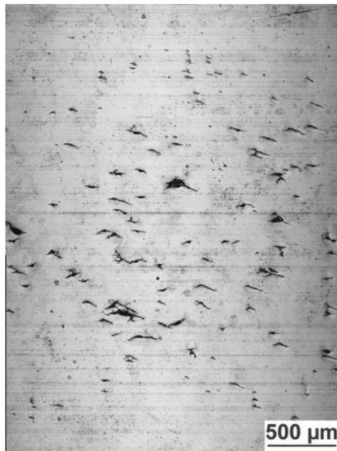
図 3.7 試験終了時（負荷回数  $48 \times 10^4$  回）の転動面
