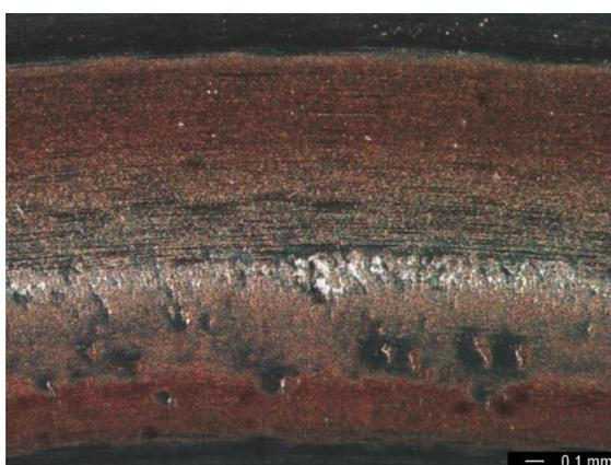
(d) 左写真ピーリング部の拡大
