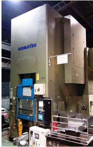
図 2.3 冷間鍛造用 AC サーボプレス外観
