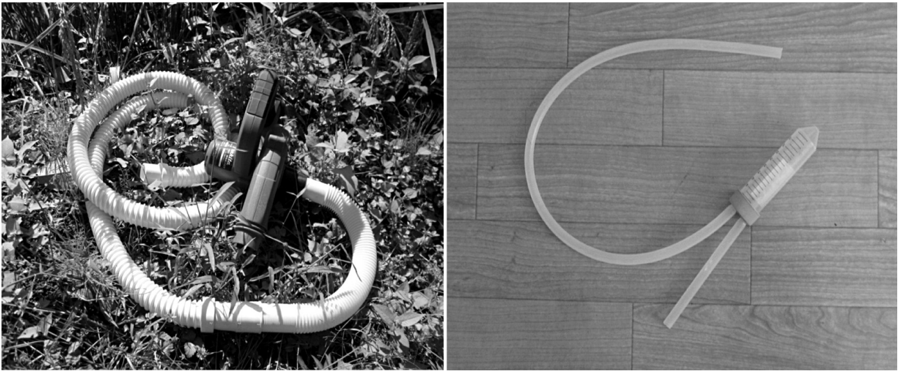
図1 バキューム法に用いたブロワー（左）と吸虫管（右）。 Fig. 1. Blower for vacuum method (left) and pooter (right).
