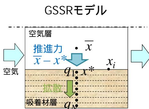
図 4.3 GSSR モデルの吸着速度式のイメージ
