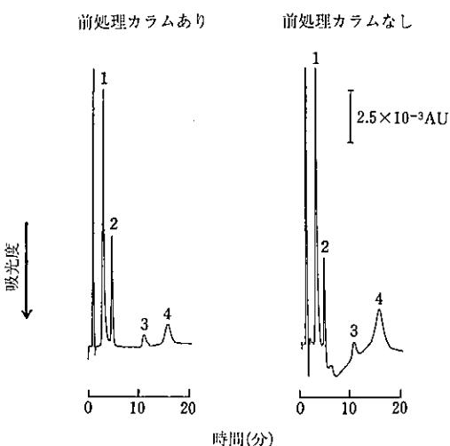
ピーケ 1: 炭酸水素イオン(0.6 mM), 2: 塩化物イオン(0.15 mM), 3: 硝酸イオン(0.06 mM), 4: 硫酸イオン(0.05 mM)
