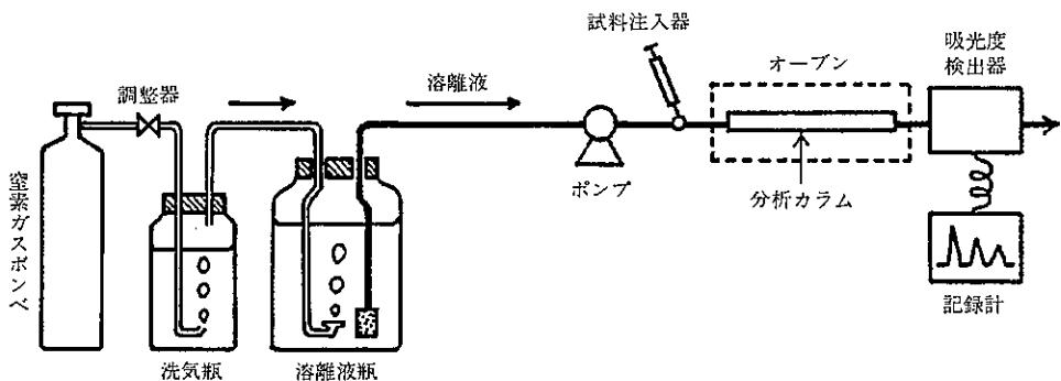
図1 窒素バージシステムを装着した吸光度検出イオンクロマトグラフ
