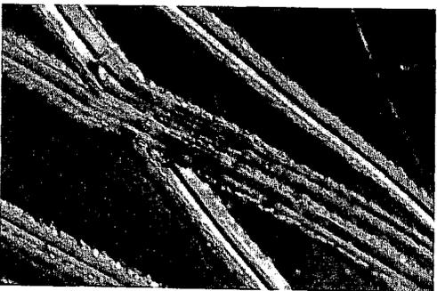
図7 銅板にめくれをつくるドライポイント線 (顕微鏡写真)
