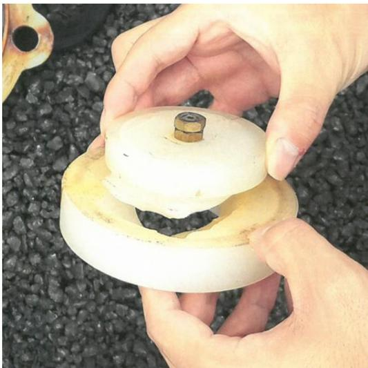
写真-2.1 破損した遊動弁体<sup>4)</sup>
