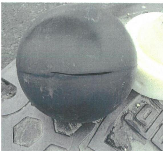
写真-2.2 破損したフロート弁体<sup>4)</sup>
