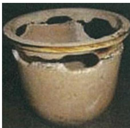
写真-2.4 案内（ガイド）の破損状況（水資源機構より提供）<sup>12)</sup>
