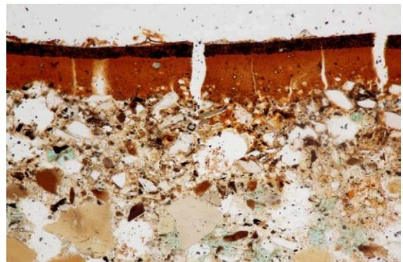
図14 朱漆容器 漆塗膜断面（透過光）
