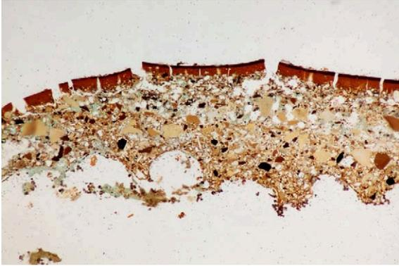
図9 朱漆容器の漆膜断面（透過光）
