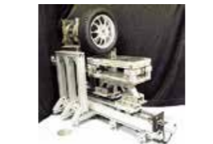
走行試験に用いるタイヤ走行模擬装置。
