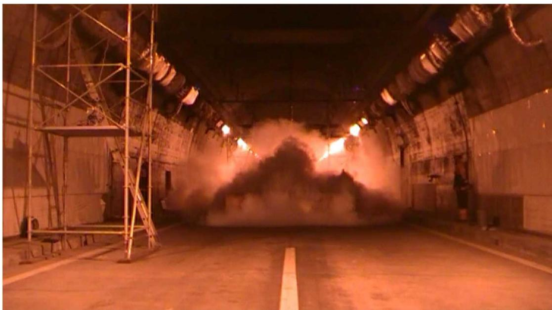
図 3-3 実大トンネル火災実験状況写真
