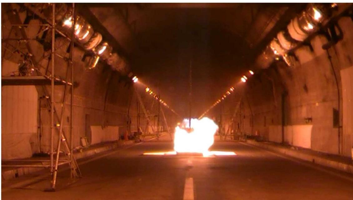
図 3-4 実大トンネル火災実験状況写真
