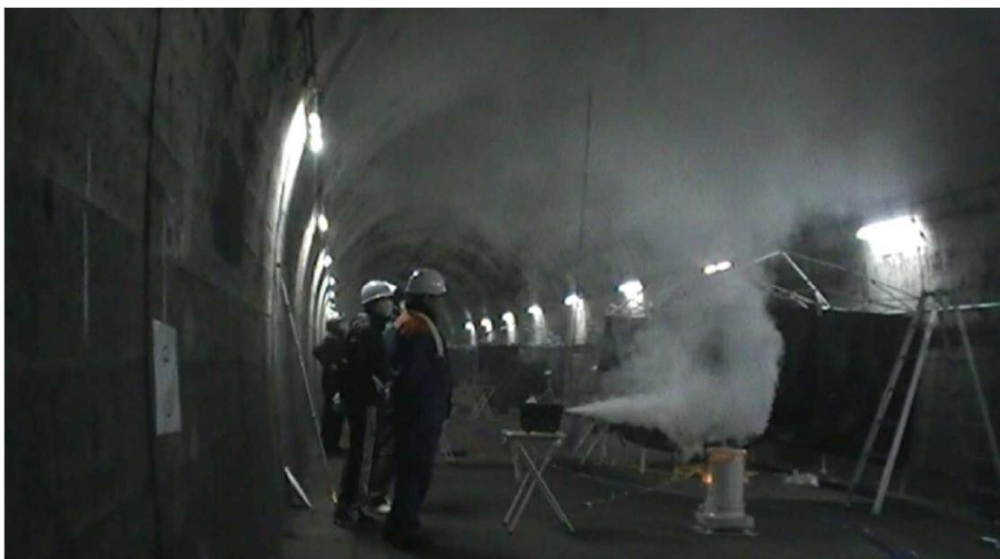
図 4-6 実験状況写真 (白色煙 120 秒後)
