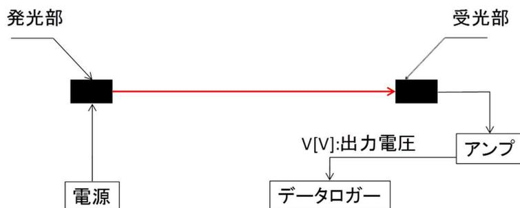
図 2-11 Cs 濃度計の接続図
