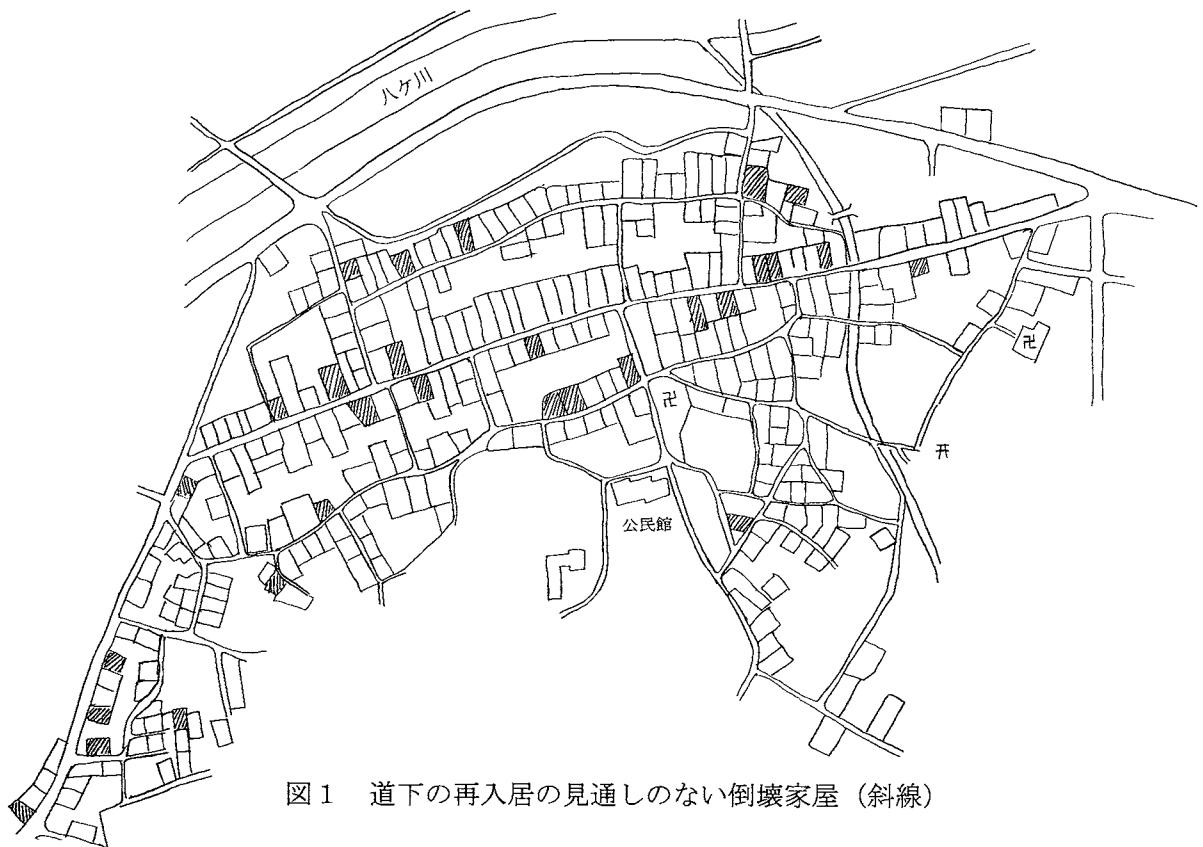
図1 道下の再入居の見通しのない倒壊家屋（斜線）
