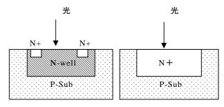
図 4 (a)PSub/Nwell 構造 (b)PS
