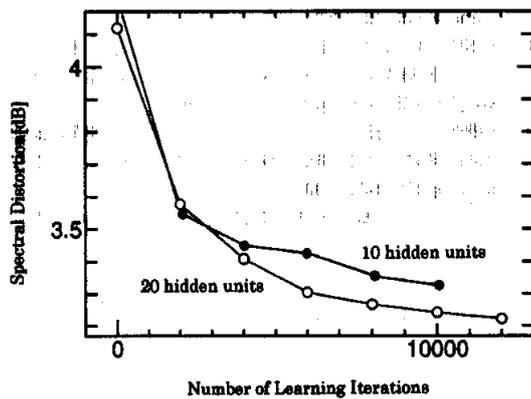
図2 5層ネットワーク 4208 フレームで学習したときのスペクトルひずみ
