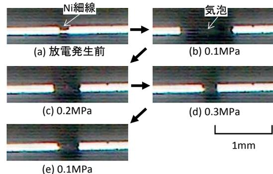
図4 圧力による気泡体積の変化
