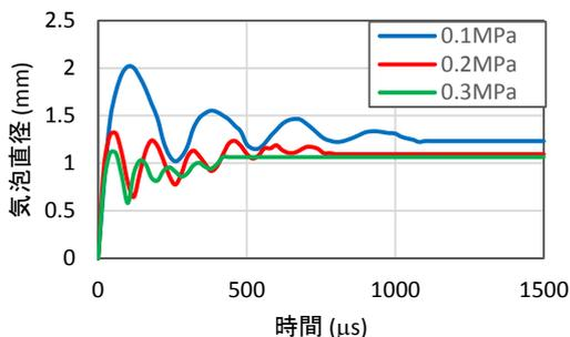
図3 時間経過に伴う気泡直径の変化
