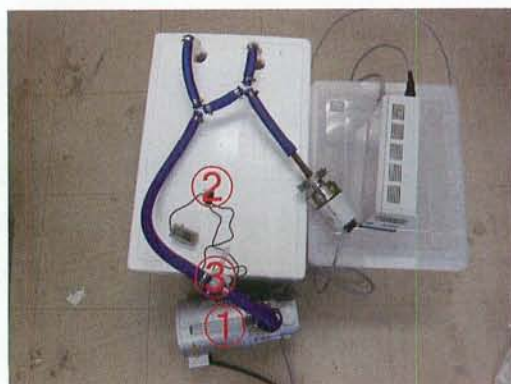
図 3-3 製作した製氷器
