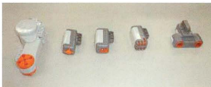
図 3: 左から、サーボモータ、タッチセンサ、光センサ、サウンドセンサ、超音波センサ
