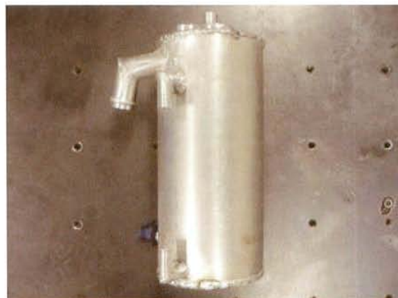
図8 オイルタンク実物写真
