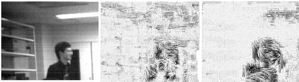
図 9 カメラ入力画像に対する従来法および提案法によるフロー (左: カメラ入力画像, 中央: 従来法フロー, 右: 提案法フロー) Fig.9 Camera Captured Image and Flows by Conventional and Proposed (Left:Camera Captured Image, Center:Conventional Flow, Right:Proposed Flow)
