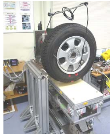
図10 路面摩擦係数測定実験
