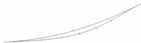
図 - 7 水平ねじり連成 1 次振動の振動モード
