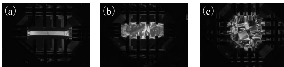
図 4 各延伸様式における試験片の配向状態 (a) 一軸延伸, (b) 幅固定一軸延伸, (c) 等二軸延伸
