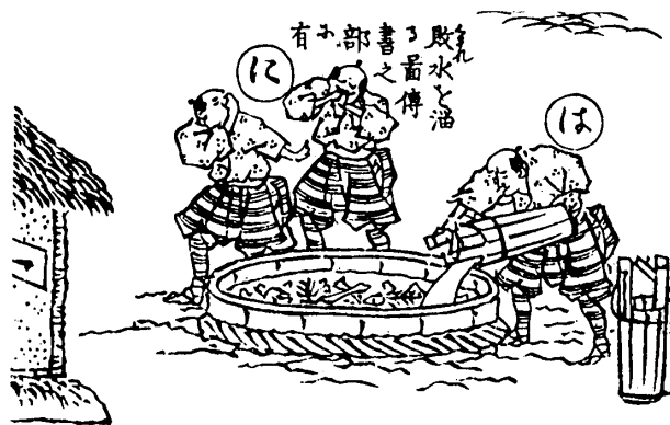
カット：佐藤信淵著 「硝石製造辨」(1854) の塩硝土仕込の図 (部分)。腐敗水も加 えるので臭いのであ ろう、鼻をつまんで いるところまでリアルに描かれている。
