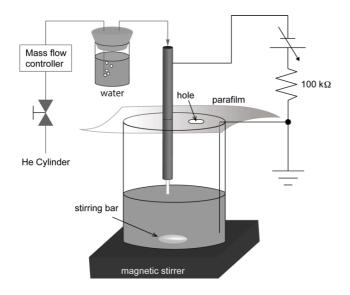
Fig. 1. Experimental apparatus.
