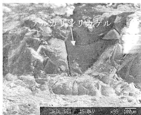
写真 1 骨材周囲に発生した ASR ゲル (SEM 画像)
