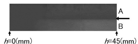
Fig.18 DEI 法による、分解能評価用ファントムの撮影結果。黒矢印は A, B 部分の境界である。コントラストが読み取れる h についての限界は 14 mm 程度である。
