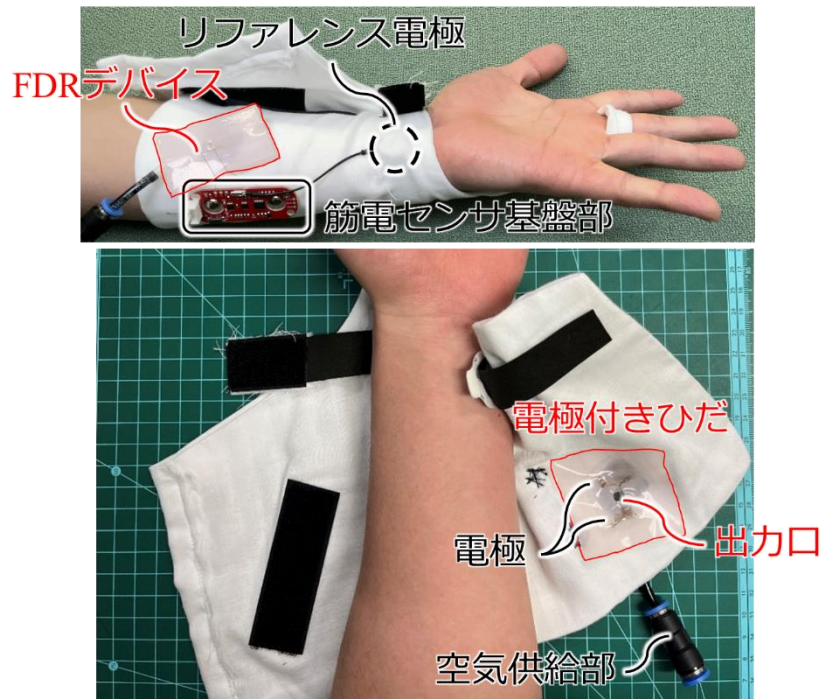
図28 FDR デバイスおよび筋電センサ内臓アームカバー
