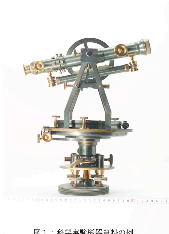
図1：科学実験機器資料の例 「経緯儀（金沢大学資料館蔵）」
