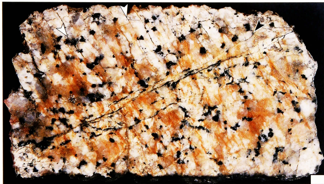
第4図. 水平ないし低角の裂か (白矢印) が高密度で発達する. 第3図のものに類似するが, 無色ないし淡赤褐色である. これを切って高角の剪断面 (黒矢印) が発達し, その面に沿って黒雲母が伸張する. すなわちこのような水平系裂かは, 面状カタクレーサイトと同等の深度で形成された. 掘削深度 1,682.90–1,682.99 m.
