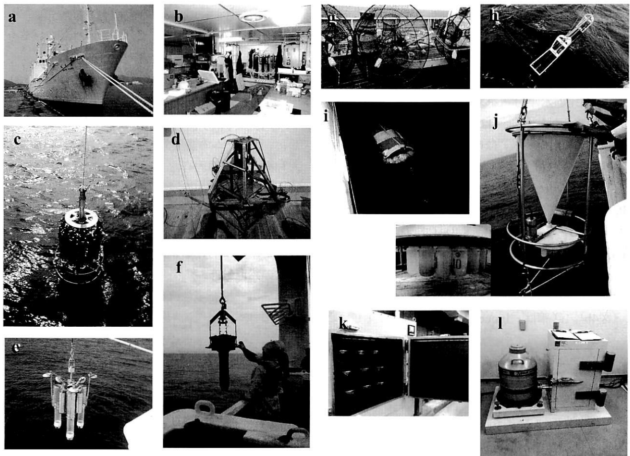
図3 放射能モニタリングの試料採取法: a) 蒼鷹丸全景 (892トン, 長さ60.0 m, 幅11.4 m), b) 船内実験室, c) ロゼット採水システムを備える電気伝導度(塩分)・水温・水深計(CTD-RMS), d) スミス・マッキンタイヤ採泥器, e) G.S.型表層採泥器, f) 重力式採泥器, g) 深海籠網, h) ベントスネット, i) ORI ネット, j) 沈降粒子捕集トラップ, k) 試料灰化処理, およびl) ゲルマニウム検出器。
