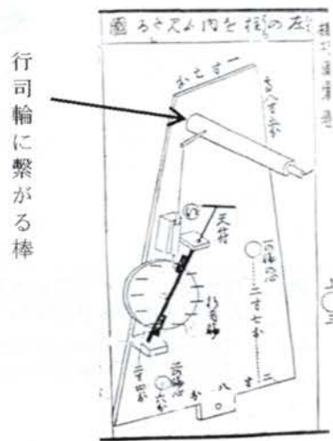
図13 「機巧図彙」の人形図(左)と弁吉の人形図(右)での腕、首の動きを制御するメカニズム。
