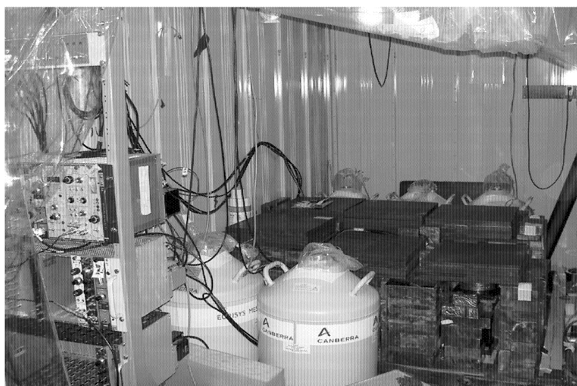
尾小屋地下測定室内部。検出器は分厚い鉛と鉄で遮蔽した中にある。緑色の容器は検出器冷却のための液体窒素の入りのデューワーである。この小屋には奥に 3 台、手前に 2 台の検出器が設置されている。
