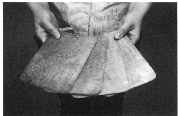
図11. 線量調節用金属板 材質：アルミニウム 大きさ：12.5×17.7cm 厚さ：0.5mm 3枚 1mm 2枚 2mm 2枚
