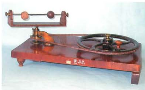
回転台と遠心力試験軽重球
