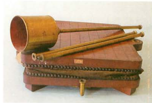
写真の下部は鞆であり, その上に銅管が載せてある (使用時の形ではない)
