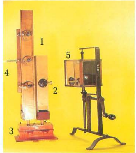
1. オルガンパイプ 2. バーナー(内部に振動膜がある) 3. 送風口 4. 石炭ガス用ゴム管 5. 回転鏡
