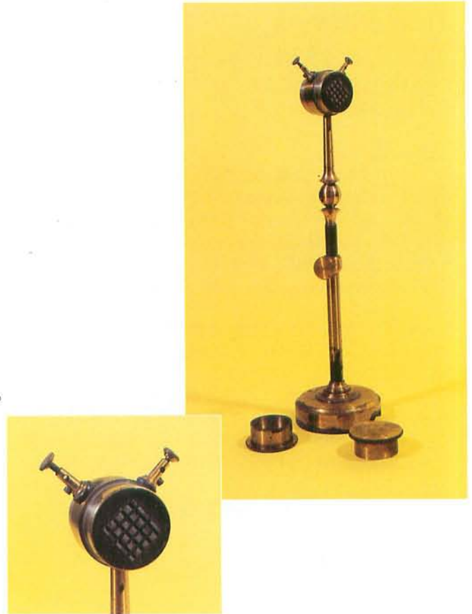
熱電堆部分拡大写真
