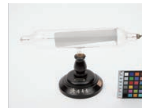
中村浅吉測量器械店製とみられるもの。磁石を近づけると、陰極線が+の極側に曲がることを示す実験に使う。 (石川県立自然史資料館蔵。学術資源リポジトリ協議会HPより)
