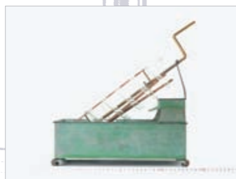
教育品製造合資会社製の螺旋吸水器 (アルキメデスのポンプ)
