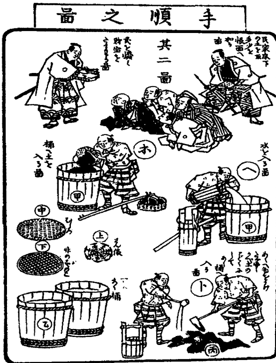
図20. 古土法による硝石の生産の図「硝石製造弁」より (50)
