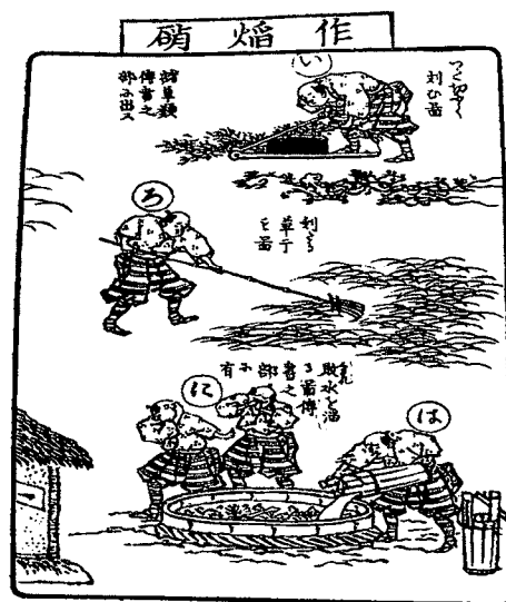
図33. 硝石丘法による腐汁を作る図(27)
