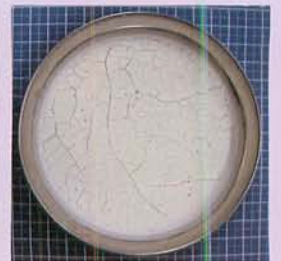
▲食用のコンスターチ(トウモロコシデンプン)を水に溶いて乾燥させたもの。平均粒径は15μm。ひび割れによって多角形が形成されている。
