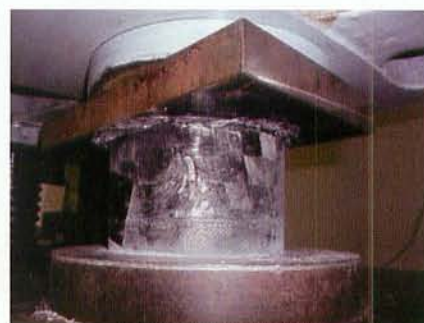
図 12 静的圧壊試験
