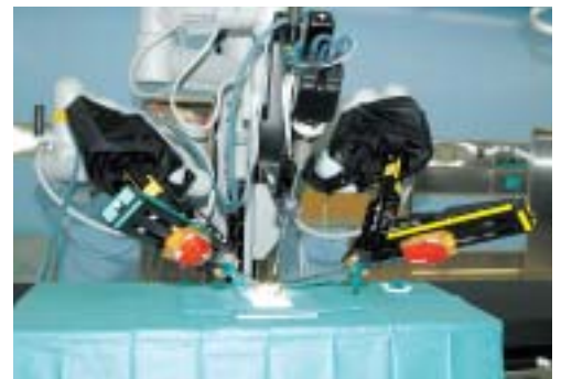
遠隔操作型内視鏡下手術装置(手術用ロボット「ダ・ヴィンチ」)
