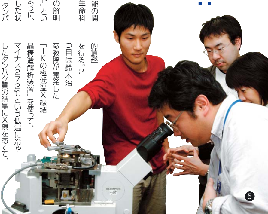
ワークショップ 高速原子間力顕微鏡で探針と標本の様子を確認している。 タンパク質が動く画像はモニターで観察する。
