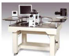
安藤敏夫とオリンパスにより共同開発された原子間力顕微鏡(2004年)
