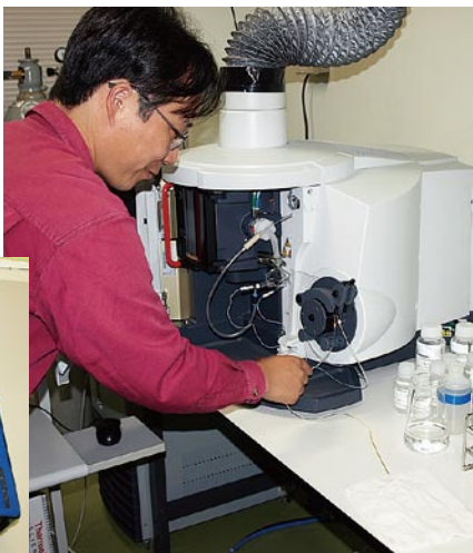
海水中の微量元素の濃度を測定するためのキット(左)と分析装置(右)
