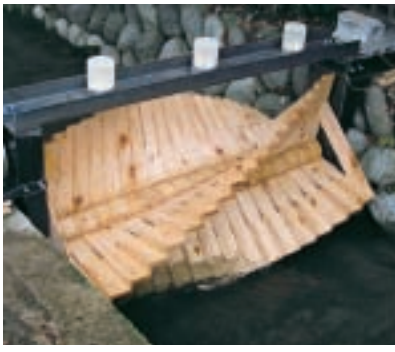
水車が回るエネルギーで光るLEDライト
