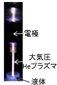
図2 大気圧非平衡プラズマジェットの液体への照射の様子
