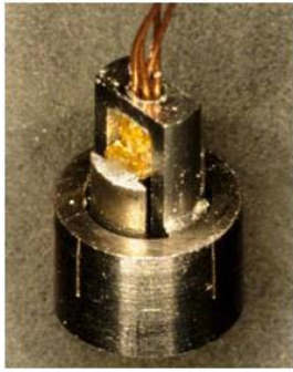
図5 リード線配線後の摩擦センサ
