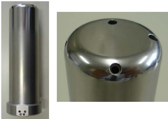
図 10 摩擦センサを組み込むカウンタパンチ
